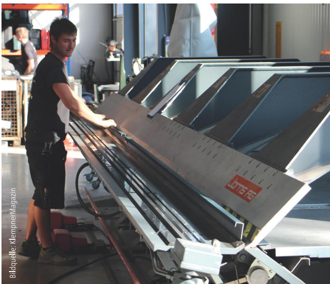
Wenn alle Metallelemente gestaltet und angeordnet sind, erfolgt die Datenübergabe an die Maschinensoftware zur Endbearbeitung.
